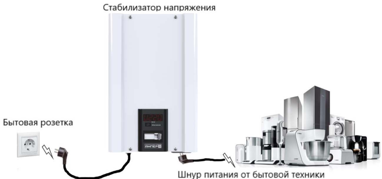
Рисунок 13. Подключение стабилизатора к сети
