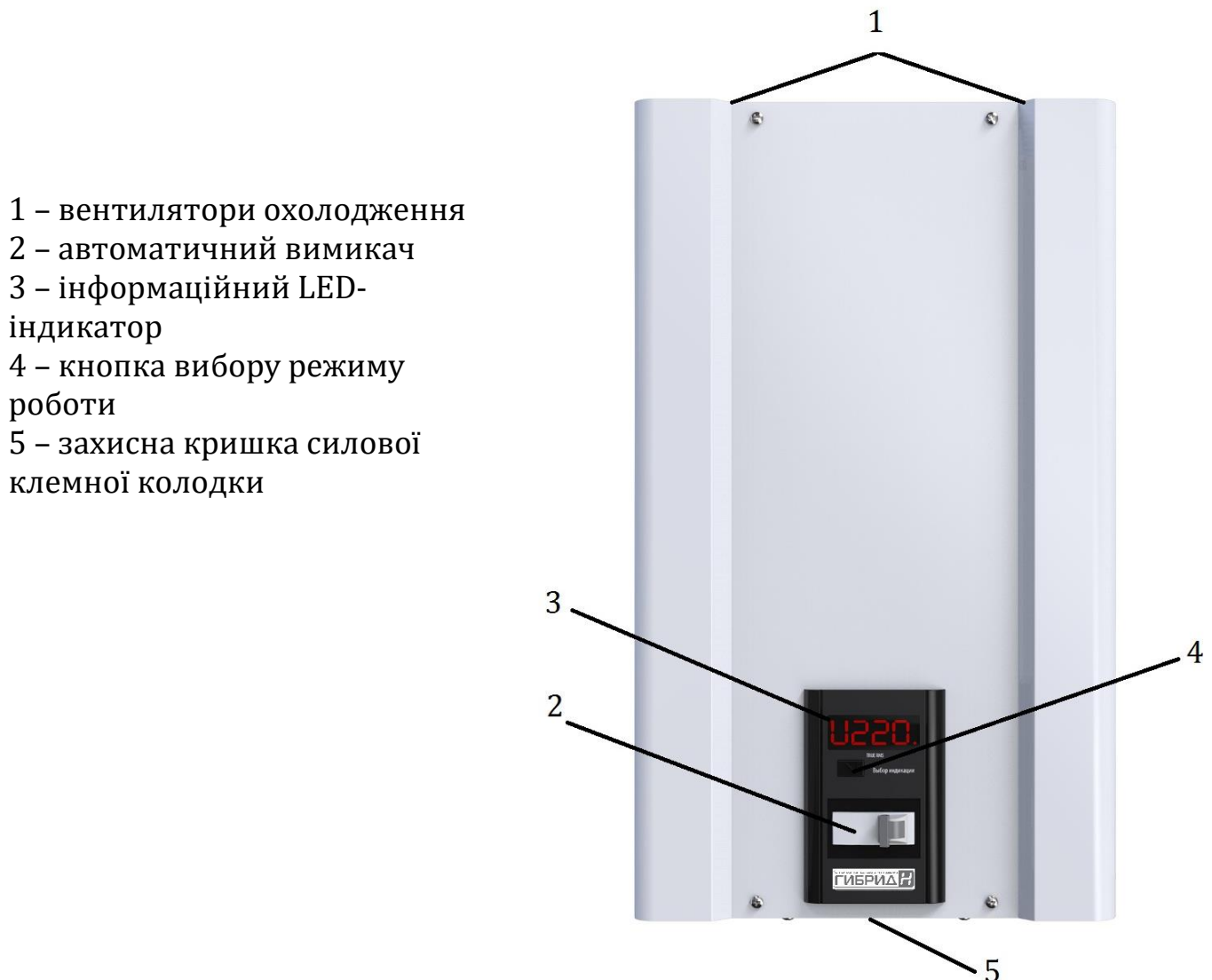
Рис.1 Зовнішній вигляд стабілізатора на 25-80А
