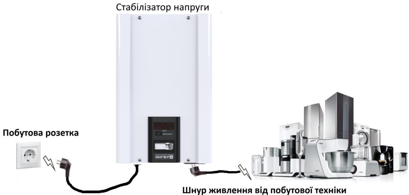
Рисунок 13. Підключення стабілізатора 5-16А до мережі
