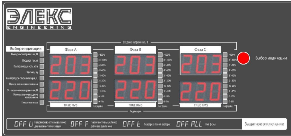
Рисунок 2. Зовнішній вигляд панелі керування Герц на 25-80А
