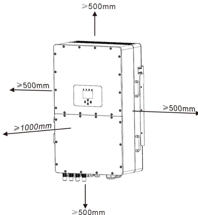
Для належної циркуляції повітря та розсіювання тепла залиште простір приблизно 50 см збоку та приблизно 50 см зверху і знизу від пристрою. І 100 см спереду.
