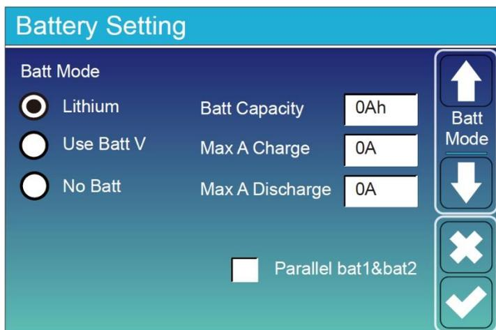
**Batt capacity:** Дозволяє гібридному інвертору визначити розмір вашого акумулятора.
