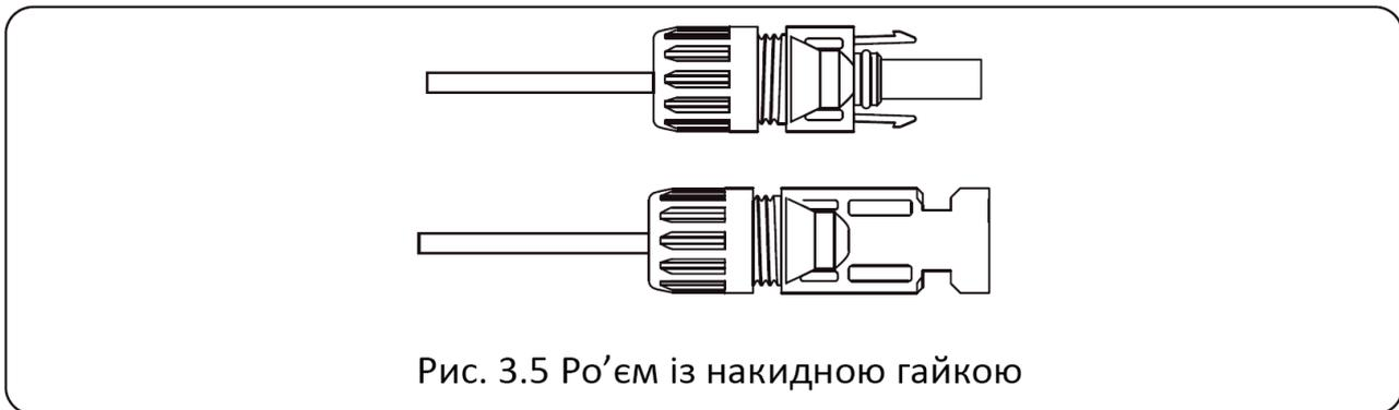
д) Нарешті, підключіть роз'єм постійного струму до позитивного та негативного входу інвертора, як показано на рис. 5.6.
