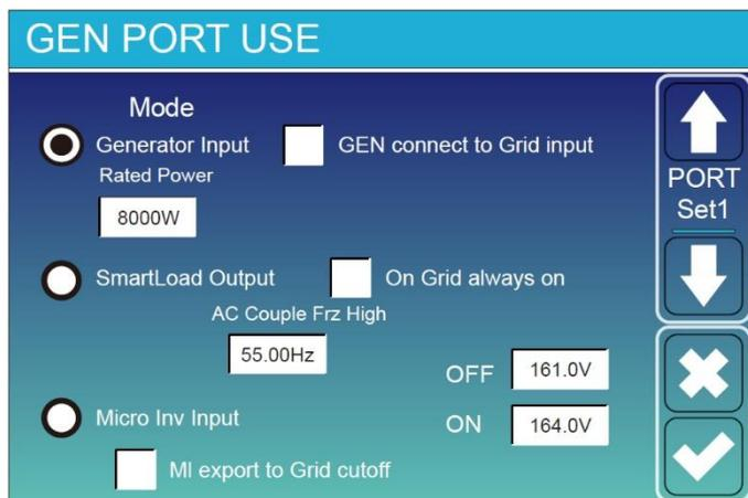
**Generator Input Rated Power (Параметри входу генератора):** Допустима максимальна потужність від дизельного генератора.
