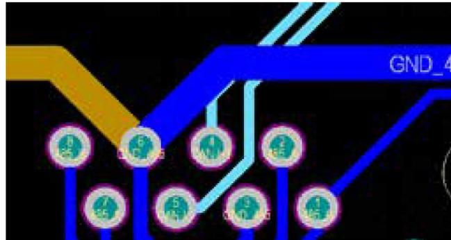
Визначення контактів порту RJ45 для BMS2.
