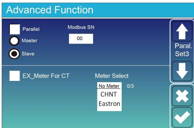
**Ex\_Meter For CT:** при використанні режиму нульового експорту в режимі СТ, гібридний інвертор може вибрати функцію "Ex\_Meter For CT" та використовувати різні лічильники, наприклад, CHNT та Eastron.
