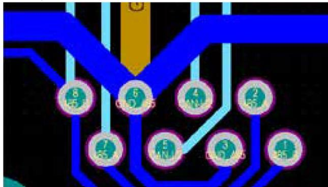
Визначення контактів порту RJ45 для лічильника
