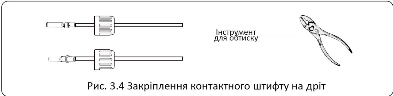
с) Вставте контактний штифт в верхню частину роз'єму і закрутіть накидну гайку до верхньої частини роз'єму (як показано на рис. 5.5).
