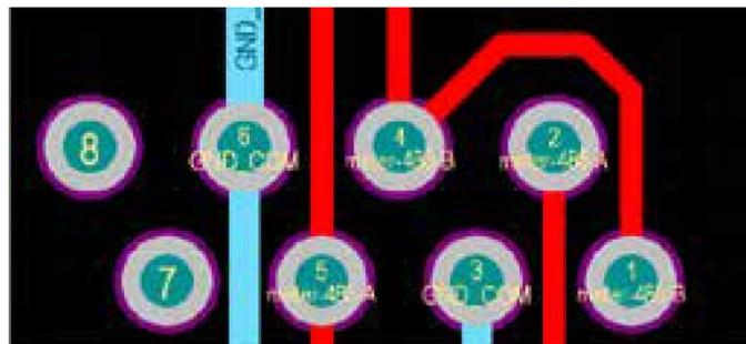
Визначення контактів порту RJ485 для RS485
