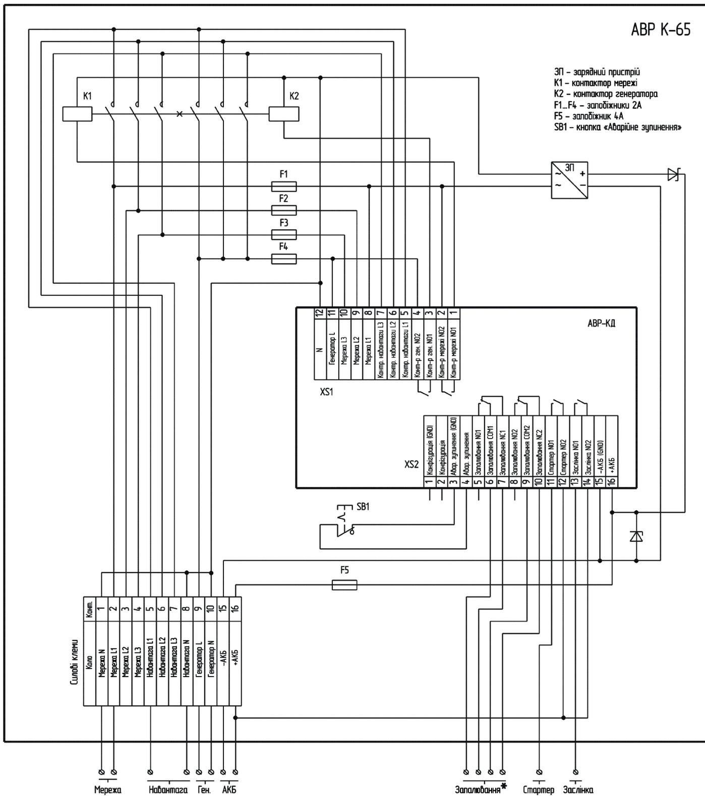
Рис. 6.6 – Приклад схеми підключення контролера АВР К-65 для однофазної мережі
