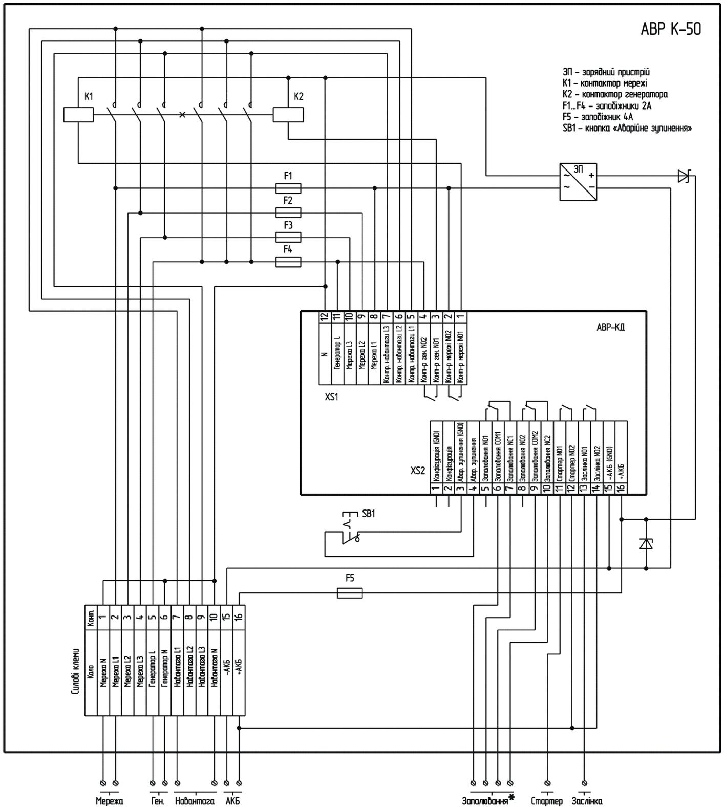
Рис. 6.4 – Приклад схеми підключення контролера ABP K-50 для однофазної мережі
