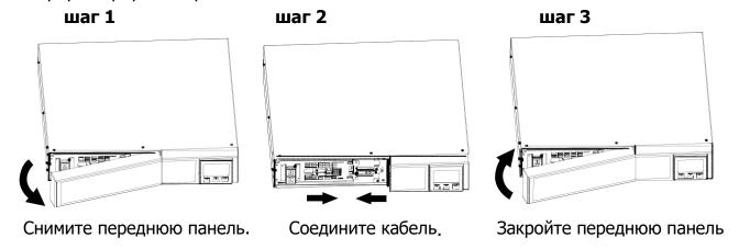
Этот ИБП может устанавливаться вертикально, либо установить в 19-дюймовую стойку.
